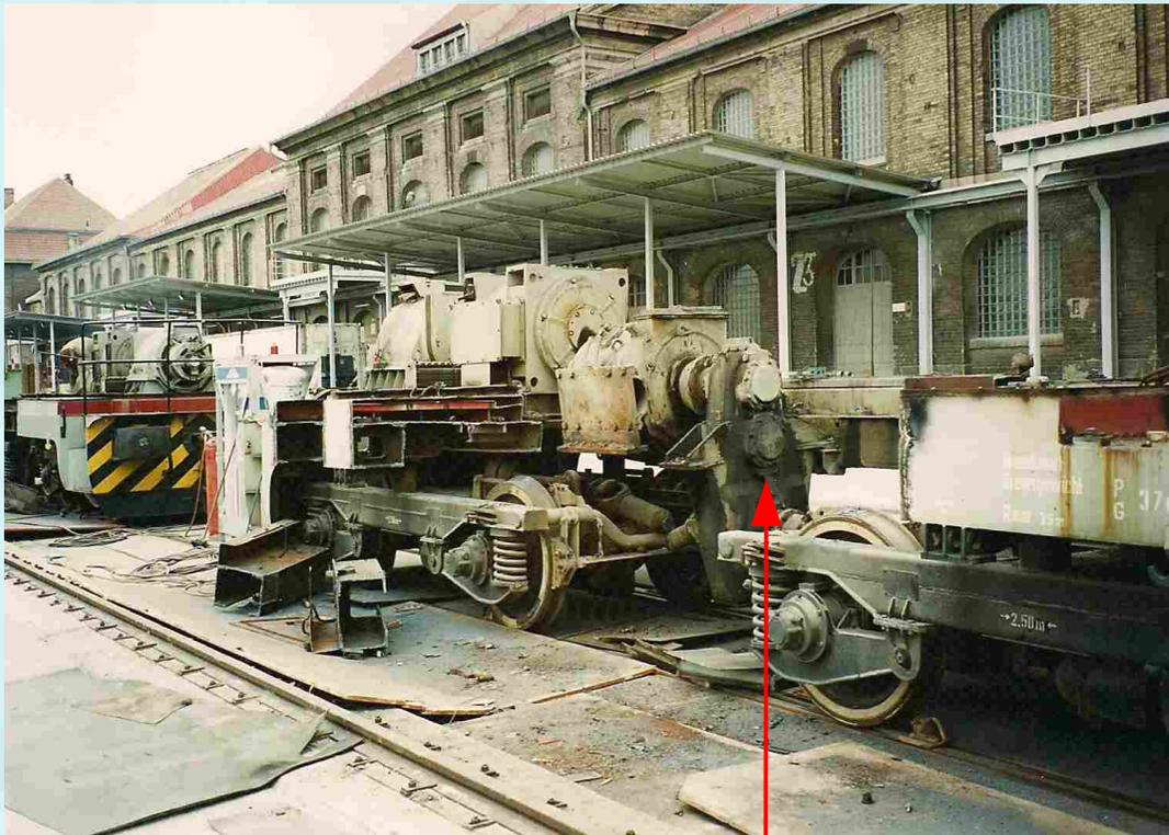
einfaches mechanisches Wendegetriebe (4)
